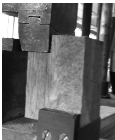
Figura 4 – Corpo de prova instrumentado para o ensaio de resistência ao cisalhamento paralelo às fibras.
